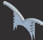
Los alerones superiores permiten una aplicación más localizada reduciendo la pérdida por deriva. Su forma curva facilita la salida de aire creando una trayectoria que mejora la aplicación del tratamiento.
