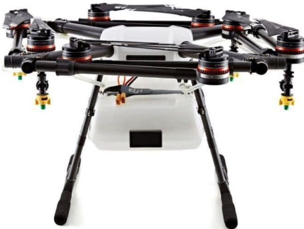
Utiliza un diseño de plegado en forma de Y que permite la instalación sin el uso de herramientas adicionales. Sus brazos de motor se pliegan hacia adentro, haciendo que el dron sea compacto y fácil de transportar en el maletero de un coche.
